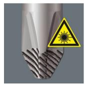
ヴェラレーザーチップはレーザー加工を通して1000 HV 0.3の硬いほどギサ歯を刃先に施します。 その競造から生じた食いつきの効果はカムアウトを防ぎます。マイナス、プラス、ポジドライブ、トルクスネジに対応可。
