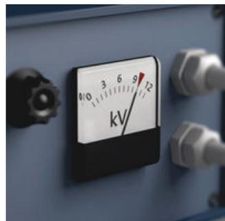
10,000ボルトで絶縁耐力をテストすることで、ツールの最も重要な性質である絶縁性がテストされているという安心感が得られます。Wera(ヴェーラ) VDE ツールは、最大1,000ボルトで安全に作業することを保証するこの試験を1点ずつ受けています。
