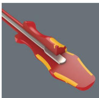
ヴェラ クラフトフォームハンドルは、異なる特性を持つ複数の素材で作られています。ハンドルのコア部分は摩耗耐性のプラスチックで作られており、大きな力が加えられても、ブレードをしっかりと掴むことができます。カラフルな柔らかいゾーンは、トルク伝達を向上させるために摩擦抵抗が大きい柔らかい素材で作られています。表面の赤いゾーンは、手がハンドルに"吸着"するのを防ぎ、ハンドルを握り直すのを容易にしています。
