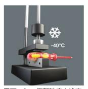
零下40℃で衝撃強度を検査 し、ハードな条件下でも安 全性を保証します。
