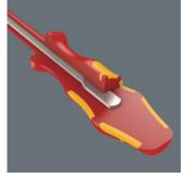
クラフトフォーム ヴェラ ハンドルは、異なる特性を 持つ複数の素材で作られて います。ハンドルのコア部 分は摩耗耐性のプラスチッ クで作られており、大きな 力が加えられても、ブレー ドをしっかりと掴むことが できます。カラフルな柔ら かいゾーンは、トルク伝達 を向上させるために摩擦抵 抗が大きい柔らかい素材で 作られています。表面の赤 いゾーンは、手がハンドル に"吸着"するのを防ぎ、ハ ンドルを握り直すのを容易 にしています。
