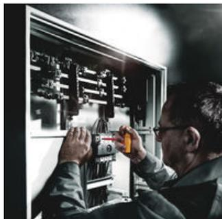
電気工事用 単能型Tハンドルトルクドライバー は絶縁耐力の個別検査済みで、最大許容負荷電圧1000ボルト
