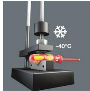
零下40°Cで衝撃強度を検査し、ハードな条件下でも安全性を保証します。
