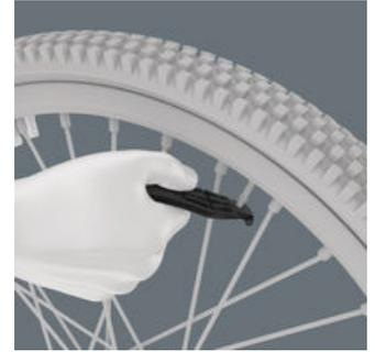
ガラス繊維強化プラスチック製タイヤジャッキを使用すると、リムを損傷することなく、タイヤを安全にリムから外すことができる。1つのタイヤジャッキでリムを持ち上げ、スポークに引っ掛け、底部のタイヤジャッキでタイヤを引き抜く。2つのタイヤジャッキは一緒にクリックできるため、個別に紛失することはない。
