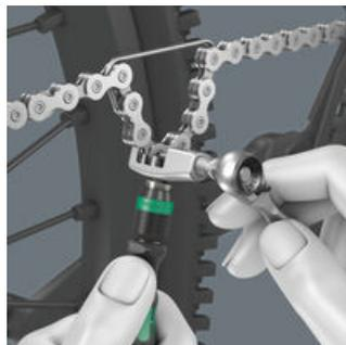
付属のチェーンツールセットで、チェーンの緩め、再接続が可能。12段変速までのシングルスピードチェーンに対応。
