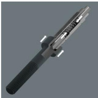
4つのネジサイズは4-in-1ビット9506および9507で操作できる。4つのサイズの六角ネジ (3.0; 4.0; 5.0; 6.0)、4-in-1ビット用の4-in-1ビット9506 3つのサイズの六角ねじ (2.5; 5.0; 6.0) および1つのサイズのTORX®ねじ (TX 25) の場合は9507。大きい方の先端形状を使用するには、小さい方の先端形状が皿穴になり、大きい方の先端形状を使用できるように、ねじ回し中にばね張力を押し続ける。
