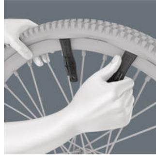
ガラス繊維強化プラスチック製タイヤジャッキを使用すると、リムを損傷することなく、タイヤを安全にリムから外すことができる。1つのタイヤジャッキでリムを持ち上げ、スポークに引っ掛け、底部のタイヤジャッキでタイヤを引き抜く。2つのタイヤジャッキは一緒にクリックできるため、個別に紛失することはない。
