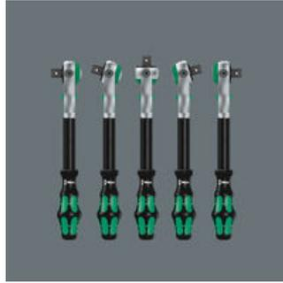
ラチェットヘッドは首を180°自由に回転でき、ホイールスイッチで回転方向の変更が可能。限られた狭いスペースで作業するときは、首の左右に0°、15°、90°の動作角度で固定できるので、滑ることなく安全に作業できます。
