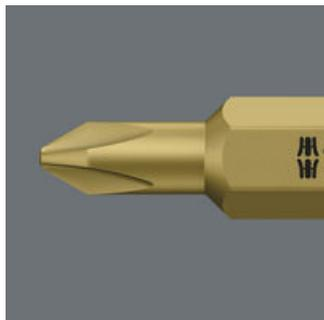
Gli inserti con gambo a diametro ridotto garantiscono che le viti si annegano nella superficie del pezzo senza danneggiarla. Particolarmente adatti per avvitiamenti nel cartongesso.
