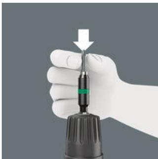
Senza dover azionare il manicotto, l'inserto può essere inserito nel portainseri. Non appena l'inserto viene appoggiato alla vite, si attiva automaticamente il dispositivo di blocco. L'inserto tiene in modo sicuro e senza gioco.
