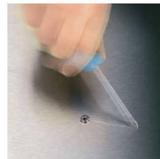
Ripetutamente accade che avvitando si scivola fuori dalla vite. Qualche volta si danneggiano delle pregiate superfici o addirittura ci si ferisce. La punta dei giravite Lasertip della Wera viene irruvidita microscopicamente con dei raggi Laser. Questa superficie ruvida si aggrappa letteralmente nella testa della vite. Lo slittamento involontario con ciò può essere evitato.
