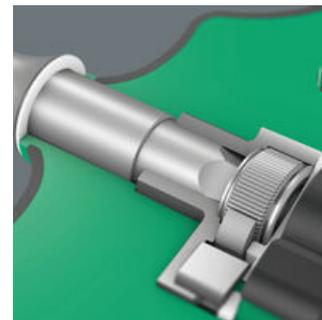
Il cricchetto integrato con dentatura fine (80 denti) con angolo di richiamo di 4,5° semplifica e accelera l'avvitamento senza faticosi riposizionamenti. Con portainseri a cambio rapido Rapidaptor per inserti da 1/4"
