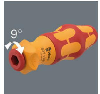
Il cricchetto integrato con dentatura fine (40 denti e un angolo di richiamo di 9°) semplifica ed accelera l'avvitamento senza fastidiose "riprese".
