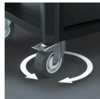
Le 2 ruote piroettanti sono dotate di un doppio arresto: la ruota frenata ne impedisce in modo affidabile lo spostamento, il cuscinetto rotante frenato impedisce alle ruote di ruotare involontariamente, ad es. su superfici in pendenza. I rulli elastici resistenti agli oli e agli acidi garantiscono un funzionamento regolare. Un anello protettivo impedisce l'ingresso di sporco e fidi.
