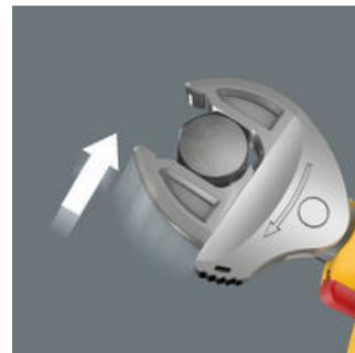
Grazie alle ganasce a guida parallela autoregolabili in continuo la chiave a forchetta Joker 6004 copre tutte le misure della gamma indicata. La misura che serve viene trovata automaticamente dalla chiave posizionandola sul dado o sulla vite.
