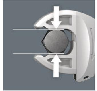
Le ganasce parallele lisce del Joker 6004 consentono una pressione della superficie e di conseguenza impediscono lo smussamento della testa della vite o del dado, cosa che può succedere attraverso la trasmissione della forza sugli angoli.
