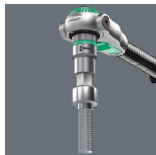
Le viti ad esagono cavo s'incastano sull'inserto-bussola grazie ad una sfera a molla sull'inserto. Specialmente utile negli spazi difficilmente raggiungibili nei quali non si può usare la seconda mano per trattenere la vite.
