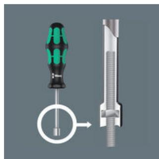
Per avvitare aste filettate servono giravite con gambo cavo, poiché l'asta filettata entra nel gambo cavo, rendendo possibile azionare il dado.
