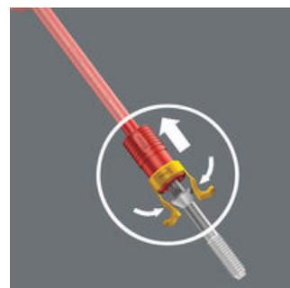
Tirare il supporto bloccavite verso l'impugnatura del giravite fino a che i due bracci del supporto aderiscano perfettamente alla testa della vite, aprendosi leggermente. Dopo l'avvitamento, il supporto della Wera si stacca automaticamente dalla vite!
