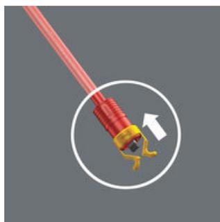
Infilare il supporto bloccavite sulla punta della lama del giravite fino a che il profilo della lama fuoriesca dall'alloggiamento in gomma.
