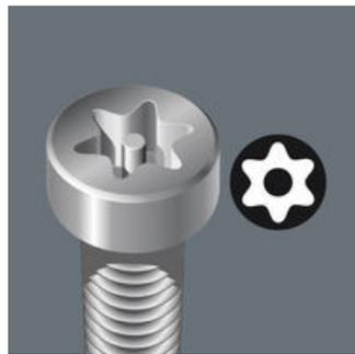
Ideato per impedire lo svitamento non autorizzato delle cosiddette viti antimanomissione. Per impedire l'uso di utensili TORX® convenzionali, sull'impronta della vite si trova un perno sporgente che viene inserito nel foro del TORX® B0 permettendo di svitare le viti antimanomissione.
