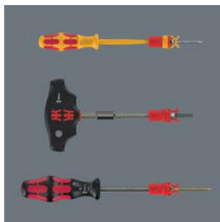
Il supporto bloccavite con funzione di ritegno per viti. Trattiene tutti i profili saldamente sull'utensile. Il bloccavite può essere spostato verso l'alto sulla lama durante l'avvitamento, in modo da non disturbare anche in situazioni di viti in profondità. Il bloccavite può essere utilizzato anche con chiavi a L e inserti lunghi!
