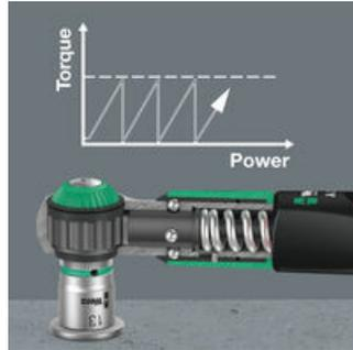
La chiave dinamometrica Safe-Torque A 1 è dotata di un meccanismo di sblocco a slittamento. Al raggiungimento del valore di coppia impostato l'utensile si blocca e quindi non è possibile applicare una coppia eccessiva.
