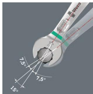
Grazie al lato a forchetta orientabile di 7,5°, alla geometria a doppio esagono e a un metodo di applicazione adattato (fissaggio, avvitatura, rotazione, riattacco, avvitatura, rotazione, ecc.), possono essere utilizzati anche in caso di avvitamenti in cui l'angolo di rotazione è inferiore a 30°.
