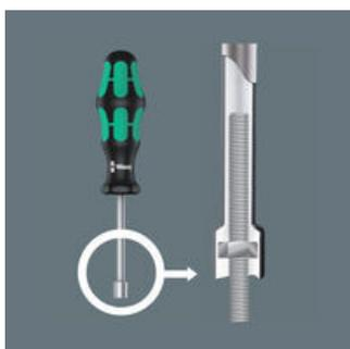
Nel caso d'avvitamenti con barre filettate ho bisogno di un giravite a gambo cavo perché solo in questo modo è possibile far passare la barra filettata con il dado nel gambo cavo del giravite.
