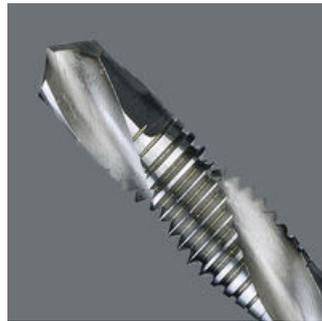
Inserto maschiatore combinato: Impiego : forare, maschiare e sbavare in un unico processo di lavoro. Il gambo da 1/4" per attacchi secondo DIN 3126-D 6,3. La trasmissione di forza ottimale grazie al gambo esagonale in acciaio HSS. L'elasticità del materiale, realizzato specificatamente per una elevata longevità. Ottime caratteristiche di centratura e filettatura senza problemi. Ottima espulsione dei trucioli. Ridotto pericolo di incastro. Corsa di ritorno precisa.
