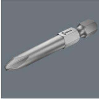
La A sta per aviazione. Sono inserti particolarmente duri con profilo a spigolo vivo per impiego con impronte di viti piene di smalto colorato, perchè riescono a spezzare lo strato di vernice garantendo un'ottima trasmissione della forza dall'inserto alla vite.
