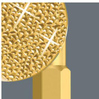
Durante l'avvitamento, le minuscole particelle di diamante si aggrappano letteralmente nella vite e provvedono ad una perfetta accoppiata e tenuta nella testa della vite. In questo modo la vite viene preservata e si riduce la forza di cam-out (scivolare) che costringe l'utente ad esercitare una pressione maggiore sulla vite.
