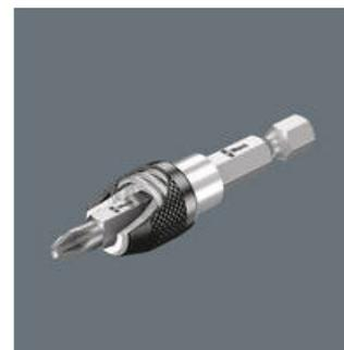
Il portainseri a cambio rapido Wera garantisce una tenuta salda e priva di gioco fra il portainseri e l'inserto. Tirando l'anello di ritegno in avanti si libera il meccanismo di ritegno e l'inserto può essere cambiato rapidamente e facilmente. Modello con magnete per appoggiare più facilmente le viti.
