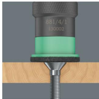
Il portainseriti 881/4/1 consente l'annegamento a filo uniforme di viti nelle tavole di legno nella costruzione di terrazze. La profondità di avvvitamento può essere regolata a seconda del fabbisogno. Ciò permette di annegare le viti non troppo in profondità.
