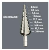
9 punte crescenti di 2 mm, da usare per materiali con uno spessore fino a 4,5 mm. Con bisellatrice (sbavatrice per lamiera), con il Ø 10, per lamiere da 1 mm
