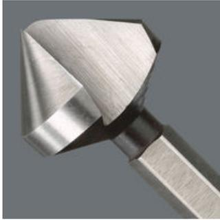
Inserto svasatore conico a un tagliente, 90°. Adatto per: sbavare e svasare. Attacco da 1/4" per porta-inserti secondo DIN 3126-D 6,3. Ottima trasmissione di forza grazie al gambo esagonale. Un tagliente garantisce assenza di saltellamenti e striature durante il lavoro. Ottima finitura della superficie della svasatura. Elevata longevità. Ottimale spulsione trucioli. Elevata protezione anticorrosiva.
