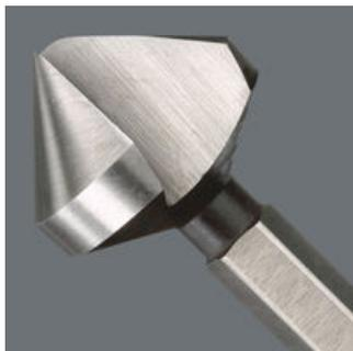
Insero svasatore conico a un tagliente, 90°. Adatto per sbavare e svasare attacco da 1/4" per porta-inseri secondo DIN 3126-D 6,3. Ottima trasmissione di forza grazie al gambo esagonale. Un tagliente garantita assenza di saltellamenti e striature durante il lavoro. Ottima finitura della superficie della svasatura. Elevata longevità. Ottimale spulsione trucioli. Elevata protezione anticorrosiva.
