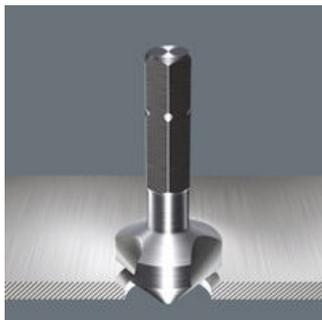
Inserto svasatore conico a tre taglienti, 90°. Adatto per: sbavare, svasare e allargare. Attacco da 1/4" per porta-inserti secondo DIN 3126-D 6,3. Ottima trasmissione di forza grazie al gambo esagonale in acciaio HSS. Elasticità del materiale specificatamente per una elevata longevità. Tre taglienti. Ottime caratteristiche di centratura. Ottime caratteristiche di taglio. Ottima rimozione dei trucioli. Ridotto pericolo di incastro. Corsa di ritorno precisa. Elevata protezione anticorrosiva.
