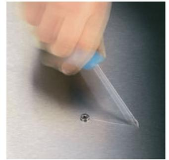
Ripetutamente accade che avvitando si scivola fuori dalla vite. Qualche volta si danneggiano delle pregiate superfici o addirittura ci si ferisce. La punta dei giravite Lasertip della Wera viene irruvidita microscopicamente con dei raggi Laser. Questa superficie ruvida si aggrappa letteralmente nella testa della vite. Lo slittamento involontario con ciò può essere evitato.
