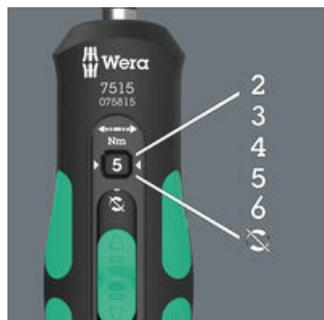
Cinque coppie di serraggio selezionabili (2,0; 3,0; 4,0; 5,0; 6,0 Nm) e una regolazione fissa (Torque Lock) per coppie di serraggio e allentamento illimitate.
