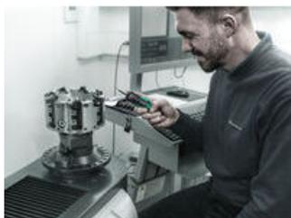
Giravite dinamometrico con regolazione rapida del valore di coppia
