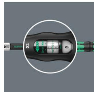
Noi volevamo che il lavoro con le chiavi dinamometriche fosse semplice e preciso. Pertanto abbiamo sviluppato le chiavi dinamometriche Click-Torque. Grazie alla facile regolazione e bloccaggio del valore richiesto e alla robusta esecuzione, queste chiavi dinamometriche sono gli utensili ideali per tutti i serraggi, nei quali è richiesto un serraggio con coppia controllata (chiave dinamometrica reversibile) e un serraggio e allentamento dell'avvitamento (chiave dinamometrica portabussola).
