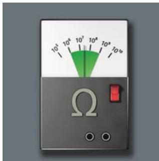
La resistenza elettrica in superficie del materiale Wera ESD ammonta a  $\leq 10^9$  ohm. In questo modo si proteggono i pezzi dall'energia elettrostatica e dai danni da essa causati.
