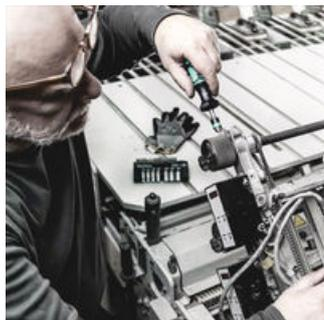
Durante i lavori di montaggio e di manutenzione molti avvitiamenti richiedono una coppia ben precisa in modo da garantirne la sicurezza del fissaggio e/o evitare danni alla vite o al pezzo. In questo caso i giravite dinamometrici regolabili della Wera sono gli utensili ideali: intervallo di coppia da 0,3 Nm a 8,8 Nm, tre impugnature diverse, precisione  $\pm 6\%$ , cambio degli inserti ultrarapido grazie al porta-inserti con tecnologia Rapidaptor.
