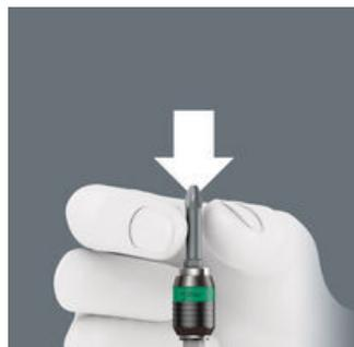
Senza dover azionare il manicotto, l'inserto può essere inserito nei portainseriti. Non appena l'inserto viene appoggiato alla vite, si attiva automaticamente il dispositivo di blocco. L'inserto tiene in modo sicuro e senza gioco.
