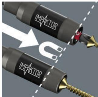
Il portainseri per avvitatori a massa battente con magneti ad anello riesce a trattenere inoltre viti grandi e pesanti, permettendo un inizio di avvitamento rapidissimo e sicuro. Ideale anche per lavori soprattutto. Se si volesse escludere il magnete, per esempio per gli avvitamenti su metallo, esso potrà essere sfilato dalla zona di avvitamento e quindi "disattivato". Viene impiegato principalmente per avvitamenti con avvitatori portatili.
