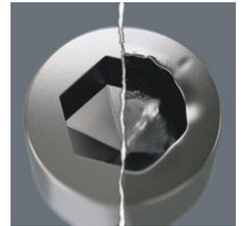
Le viti a esagono cavo sono problematiche perché la loro superficie d'appoggio, che trasmette la forza dall'utensile alla vite, è molto ridotta. Ciò favorisce la deformazione della testa della vite. Gli utensili Hex-Plus dispongono di una superficie d'appoggio maggiore che riducono quindi questo problema. Buono a sapersi: gli utensili Hex-Plus sono adatti per ogni vite a esagono cavo convenzionale!
