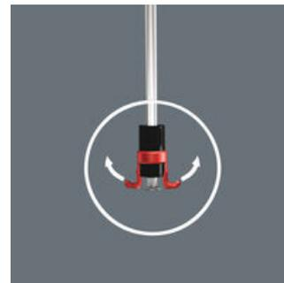
Al contatto con la superficie, i due bracci del supporto si aprono ulteriormente e una volta che la vite è entrata del tutto nel pezzo, essi si aprono completamente.
