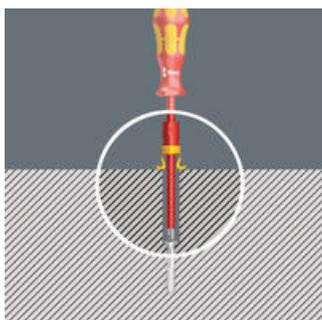
Nel caso d'avvitamenti in fori ciechi, il supporto si muove verso l'alto permettendo di raggiungere anche fori più profondi.
