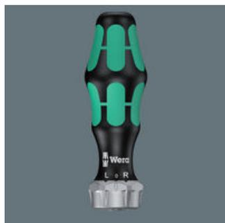
Per lame Vario della Wera da 6 mm. Cricchetto a dentatura fine con un angolo di richiamo ridotto, invertitore (rotazione a destra, al centro bloccato, rotazione a sinistra), coppia massima di 50 Nm; attacco a esagono cavo da 6 mm.
