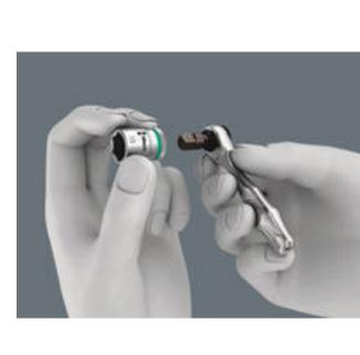
Inserti e bussole. Gli inserti posso montarli direttamente, ma posso anche montare un portainseri che mi trattiene l'inserto. Questo poi mi funge anche da prolunga con manicotto flottante. Per montare le bussole necessito di un adattatore da 1/4" esagonale quadro, p.es. 870/1 (contenuto nel Bit-Check o nel kit con il singolo cricchetto per inserti).
