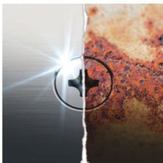
L'acciaio inox non arrugginisce. Ma se per elementi o viti in acciaio inox vengono usati utensili non in acciaio inox, si possono staccare delle particelle che aderiscono sulla superficie e arrugginiscono. Questa cosiddetta ruggine impropria non pregiudica soltanto l'estetica ma può causare anche danni strutturali che richiedono lavori di riparazione a costi non indifferenti. Usando utensili in acciaio inox, si evita l'abrasione di particelle che causano la formazione di ruggine impropria.
