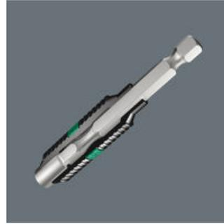
Il porta-inserti BiTorsion della Wera dispone di zona elastica a torsione che assorbe picchi di carico ridotti durante l'avvitamento. Usandolo assieme agli inserti BiTorsion con la loro zona di torsione, prolunga notevolmente la durata dell'utensile. I porta-inserti BiTorsion della Wera possono anche essere usati con inserti tradizionali.
